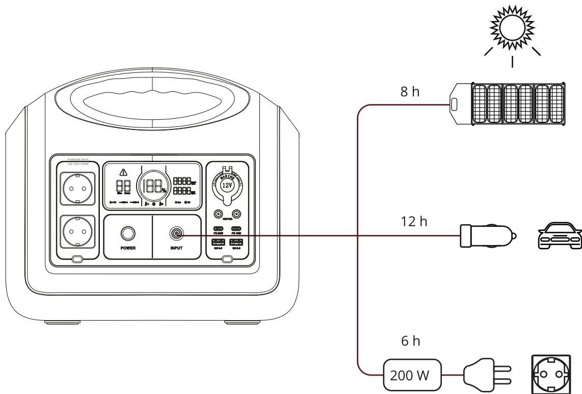
1. Для зарядки портативной электростанции с помощью солнечной панели, подключите 240W солнечную панель к порту DC 7909. Для достижения максимальной эффективности преобразования энергии, держите солнечную панель под прямым углом к источнику света. При достаточном освещении, время зарядки составит 8 часов.
