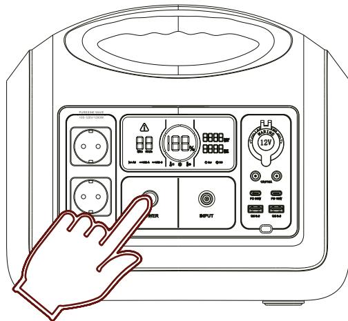
Для выключения портативной электростанции нужно нажать и удерживать в течение 2 секунд кнопку управления портативной электростанцией. Подсветка кнопки и LCD экран выключается одновременно.
